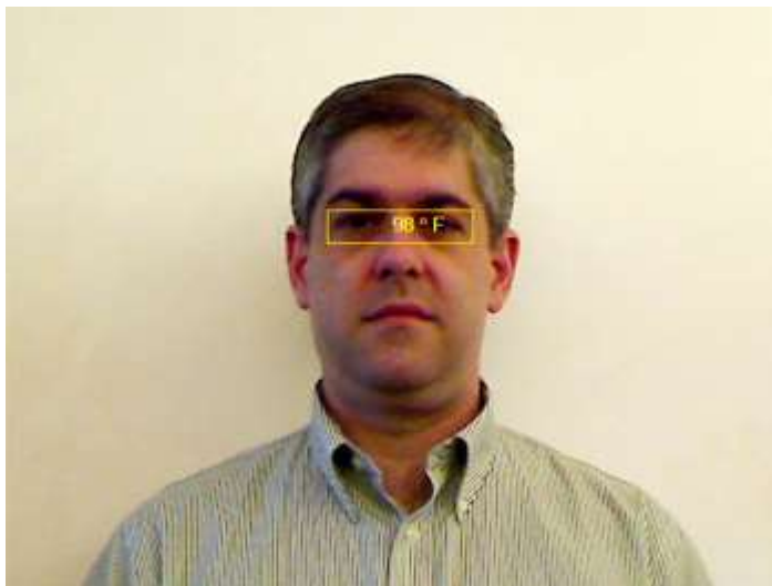
圖 6: 校準後的影像與讀到的溫度值
